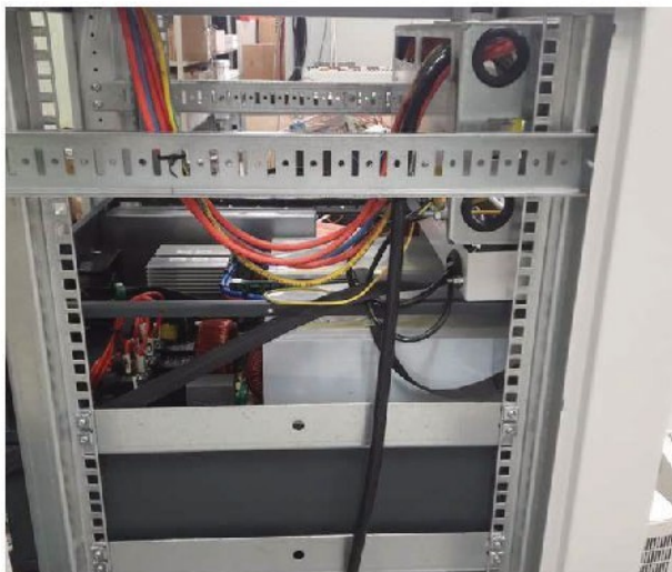
Рисунок 19. Крепление кабелей в изделии
